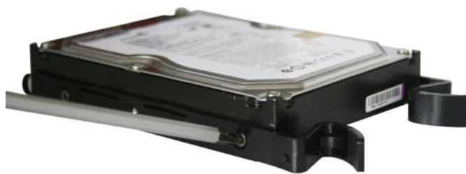
Рисунок 2. 1 Закрепление салазок жесткого диска
