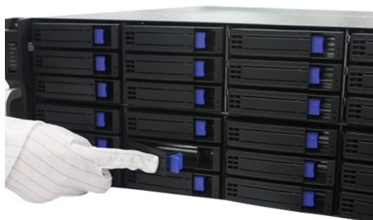
Рисунок 2. 11 Установка отсека для HDD в слот (2)
