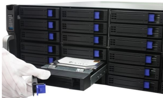
Рисунок 2. 10 Установка отсека для HDD в слот (1)
